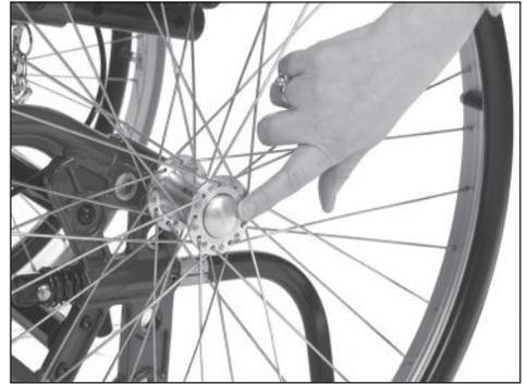
**!** Pour vérifier que la roue principale 24" est correctement fixée au moyeu, retirez le doigt du bouton central et tirez sur la roue principale.
